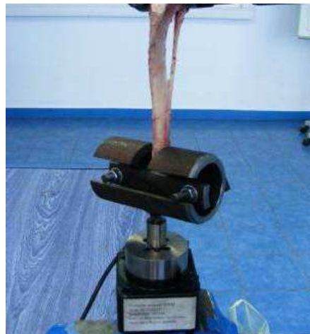
Figura 6-3.2. Dispozitiv de prindere pentru încercarea la torsiune
