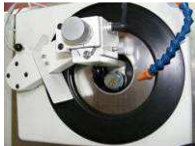
Fig. 2-1.3. - Aspectul microtomului cu speciamele pregătite pentru secționare
