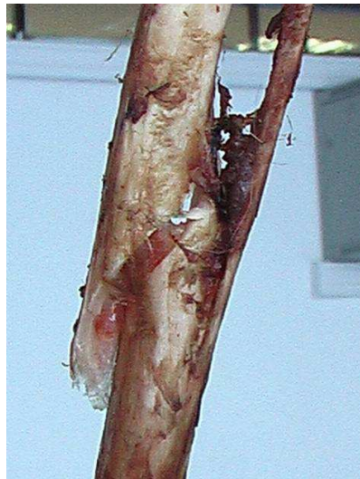
Figura 3.2 - Fractura produsă tibie la solicitarea de torsiune
