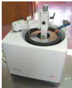
Fig. 2-1.3. - Aspectul microtomului cu speciamele pregătite pentru secționare
