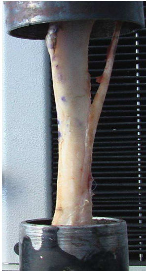
Figura 9- 3.2. Tibie supusă la compresiune – fixată în dispozitivul de prindere
